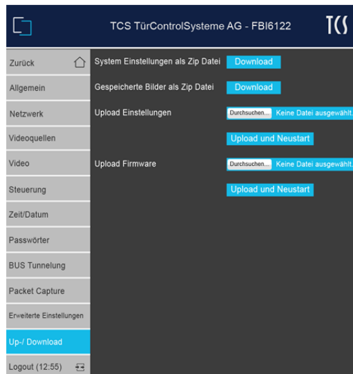
Abb. 45: Sichern der Gerätekonfiguration
