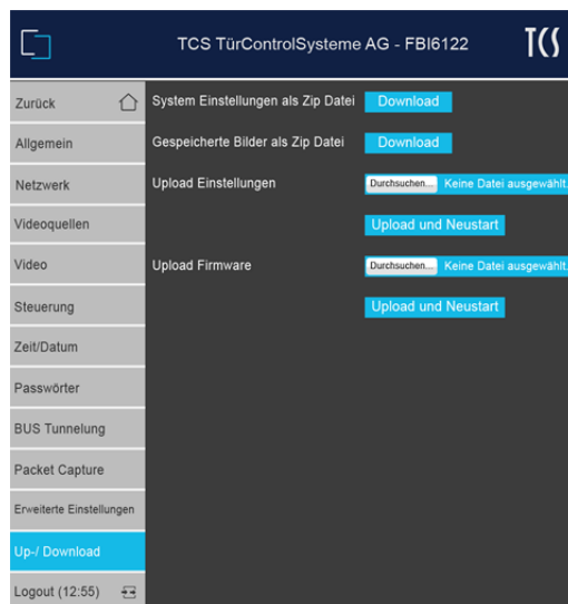
Abb. 46: Laden der Gerätekonfiguration
