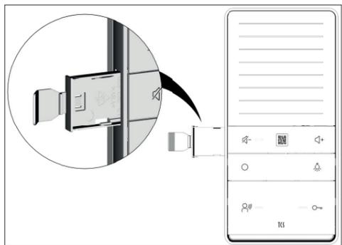
Bewahren Sie den Blindeinschub für einen möglichen Rückbau an einem sicheren Ort auf.
