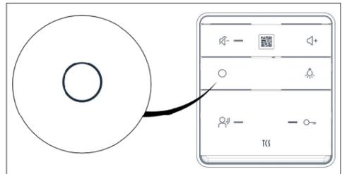
Leuchtet die Ambientebeleuchtung der Innenstation grün, kann der Smart Stick in der Innenstation verwendet werden.
