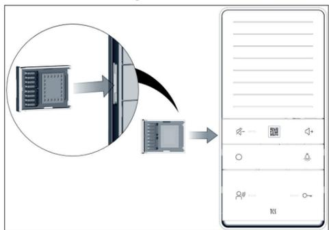
Die Ambientebeleuchtung leuchtet kurz grün. Der Smart Stick wurde erkannt. Der Smart Stick ist für die Benutzung bereit. Das DECT-Gerät verbindet sich automatisch mit dem Smart Stick und kann verwendet werden.
