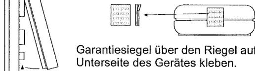
Garantiesiegel über den Riegel auf der Unterseite des Gerätes kleben.
