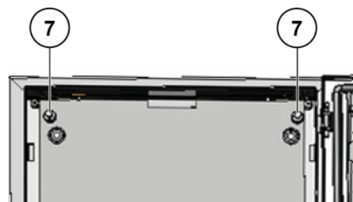
Abb. 11: Gewindebolzen für Halteseil
