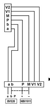
Brücken Sie Klemmen b und M am Versorgungs- und Steuergerät.
