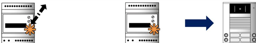
Drücken Sie kurz die RUN/PROG-Taste. Die LED leuchtet.
