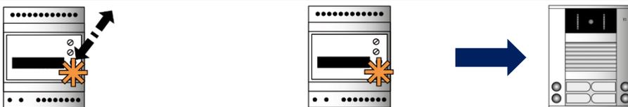
Drücken Sie kurz die RUN/PROG-Taste. Die LED leuchtet.
