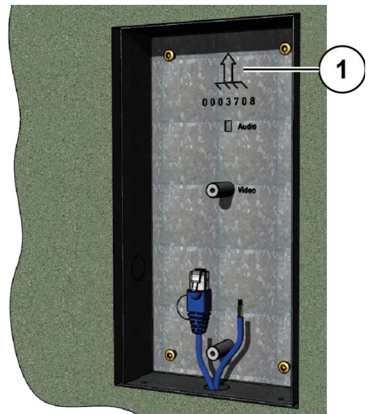
Abb. 3: Einbau des Unterputzkastens
