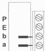
Es ist lediglich der TCS-BUS an den Klemmen a und b des Gerätes anzuschließen. Bei mehr als 2 parallel geschalteten Lätewerken ist zusätzlich die P - Ader erforderlich.
