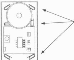
Zum Festschrauben stehen mehrere Befestigungslaschen zur Auswahl. Das Gerät kann auch auf 55 mm Unterputzdosen montiert werden.
