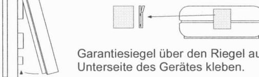
Garantiesiegel über den Riegel auf der Unterseite des Gerätes kleben.
