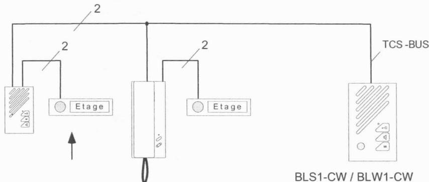
Die Geräte dürfen an beliebiger Stelle der TCS-BUS Leitung angeklemt werden. Sie können **alternativ einzelnen Wohnungssprechstellen oder Klingeltasten** zugeordnet werden. Die Ansteuerung des BLS1-CW / BLW1-CW erfolgt mittels codierter Signale über den TCS-BUS, somit können bei Modernisierungen sehr einfach vorhandene Zusatzläutewerke ersetzt werden. Zusatzleitungen sind nicht erforderlich. Für den Anschluß eines Rufasters ( z.B. Etagenruf ) stehen zwei Klemmen zur Verfügung.
