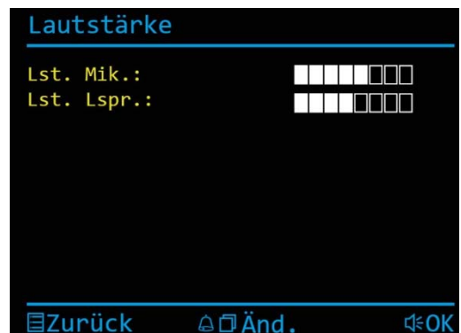
Abb. 18: Einstellen von Mikrofonempfindlichkeit und Lautsprecherlautstärke
