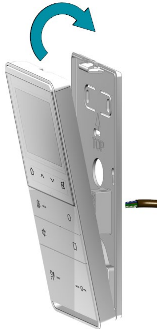
Abb. 7: Gerät aufrasten /entfernen
