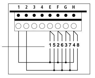
Außenstation im 2-Draht-Sonderbetrieb
