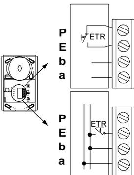
Stehen nur 3 Adern zum Gerät zur Verfügung, muß die a oder b Busader benutzt werden.
