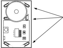
Zum Festschrauben stehen mehrere Befestigungslaschen zur Auswahl. Das Gerät kann auch auf 55mm Unterputzdosen montiert werden.
