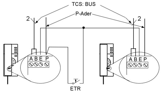
**Achtung:** An der Türstation muß das zweite Telefon in gleicher Weise auf die Klingeltaste programmiert werden, wie das erste Telefon. Es können maximal 2 Telefone auf jede Klingeltaste programmiert werden.
