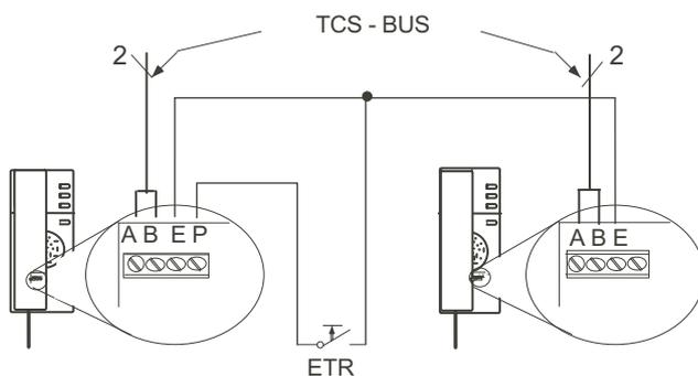
**Achtung:** An der Türstation muß das zweite Telefon in gleicher Weise auf die Klingeltaste programmiert werden, wie das erste Telefon. Es können maximal 2 Telefone auf jede Klingeltaste programmiert werden.
