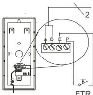
2 - Drahtbusleitung beliebig an den Klemmen A und B anschließen. An Klemme E und P wird der Etagenruftaster (ETR) angeschlossen.
