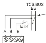
Stehen nur 3 Adern zum Telefon zur Verfügung, muss die A oder B Busader benutzt werden.
