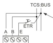
Stehen nur 3 Adern zum Telefon zur Verfügung, muss die A oder B Busader benutzt werden.
