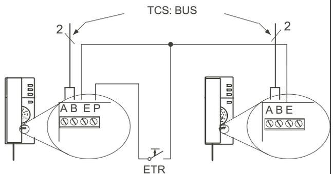
**Achtung:** An der Türstation muss das zweite Telefon in gleicher Weise auf die Klingeltaste programmiert werden, wie das erste Telefon. Es können maximal 2 Telefone auf jede Klingeltaste programmiert werden.
