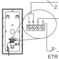
TCS:BUS Leitung beliebig an den Klemmen A und B anschließen. An Klemme E und P wird der Etagenruftaster (ETR) angeschlossen.
